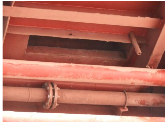
3番貨物倉の船尾隔壁に換気孔が開いている。鋼製の隔壁は、居住区域と穀物倉との境界としても使用されている。
