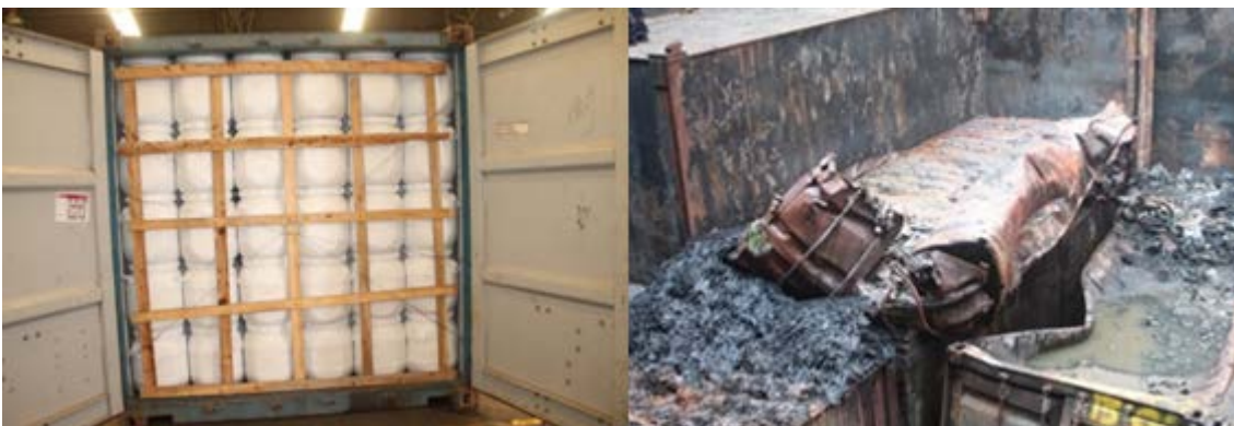
熱を逃がす隙間がない状態の次亜塩素酸カルシウムの貨物 - 避けられない結果に
