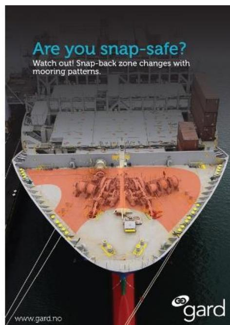
摩耗した係留索の使用、ブレーキの締めすぎ、船舶の急な動きなどが、破断荷重を超過して係留ロープが破断する主な原因になっています。Gardにも、保険金請求事由として、係留索の破断に伴う深刻な怪我や死亡事故が報告されています。
