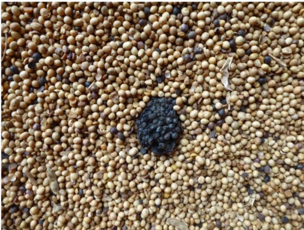
图 3：结成小块的热损大豆零星地散布在整堆货物中，这与大豆在装船前经历自热或“闷仓”的情况相符。
