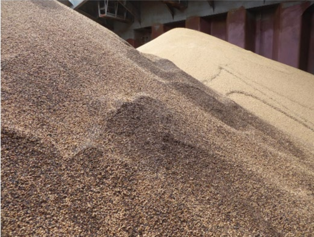
图4：前景中是装船前受到热损（或闷仓）的大豆，而背景中是完好的大豆，都装在同一货舱中。
