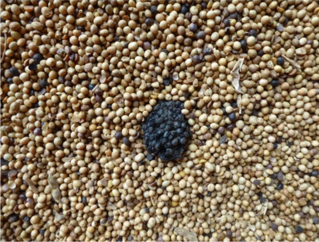
圖 3：結成小塊的熱損大豆零星地散佈在整堆貨物中，這與大豆在裝船前經歷自熱或“悶倉”的情況相符。
